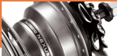
14. Das Nabengehäuse bei der Montage auf die Getriebeeinheit leicht gegen den Uhrzeigersinn drehen.
