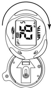
Der C-25 verwendet einen exklusiven Drehverschluss, welcher verhindert, dass sich der Computer von der Halterung im Falle eines Sturzes oder im Gelände löst. Die Halterung ist auch mit speziellen Kontakten ausgerüstet, welche einen Kurzschluss bei Feuchtigkeit verhindern sollen.
