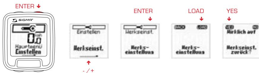
Nachdem der SIGMA ROX 8.0 auf Werkseinstellung zurückgesetzt wurde, kehrt der Fahrradcomputer in den Tiefschlafmodus zurück.
