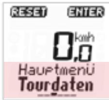
In diesem Block ist die ausgewählte aktive Funktion angezeigt, unabhängig in welchem Menü/Untermenü Sie sich befinden.
