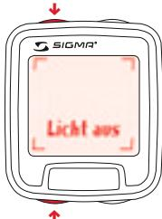
Der SIGMA ROX 8.0 ist mit einem Lichtmanager ausgestattet. Das Licht kann aktiviert bzw. deaktiviert werden (siehe hierzu folgende Zeichnungen). Bei aktiviertem Licht, wird mit jedem Tastendruck das Licht angeschaltet und leuchtet 3 Sekunden lang – vorausgesetzt, es wird keine Taste innerhalb dieser 3 Sekunden gedrückt. Die Anzeige ändert sich durch die Bedienung des Lichtes nicht.
